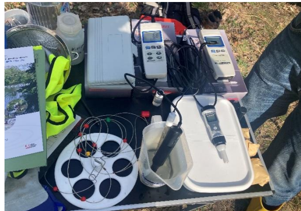
Messung der elektrischen Leitfähigkeit, des Sauerstoffes und des PH-Wertes
